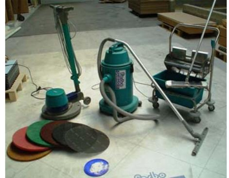
\*) Nota: Los discos de limpieza/pulido para las máquinas monodisco presentan un código de color diferente en función de su grado de abrasión. El negro corresponde al grado más abrasivo y el rojo el menos abrasivo. El amarillo o el blanco no son abrasivos y se utilizan para pulir en seco el pavimento para conseguir un aspecto más brillante.
